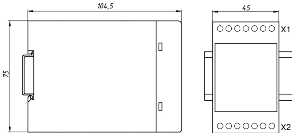
Рисунок 2 – Габаритные и присоединительные размеры преобразователя
