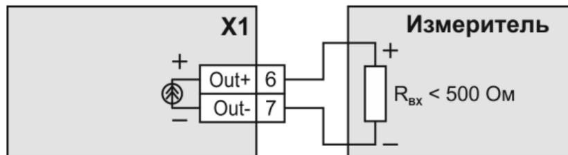
Рисунок 6 – Подключение токового выхода
