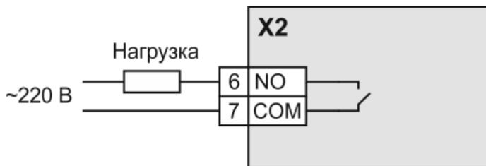
Рисунок 5 – Релейный выход (Сигнализация)
