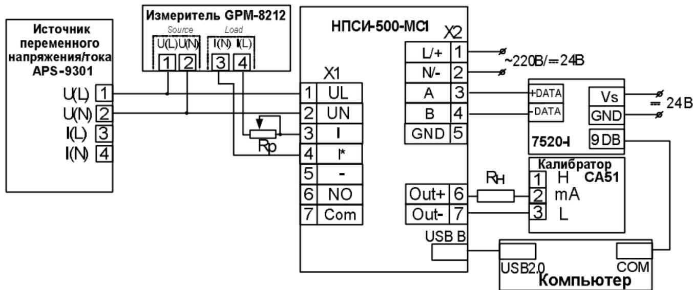
Рисунок А.6.4.1 – Схема поверки преобразователя НПСИ-500-МС1 при измерении активной мощности нагрузки
