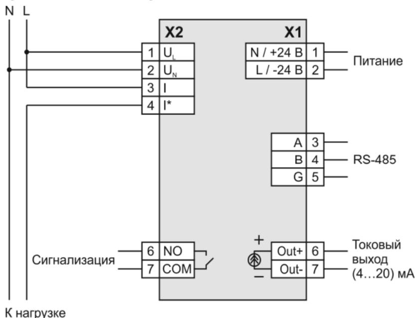
Рисунок 3 – Подключение преобразователя к однофазной электросети без применения измерительных трансформаторов
