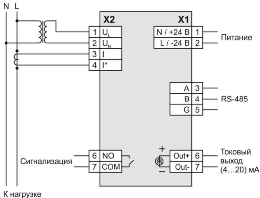
Рисунок 4 – Подключение преобразователя к однофазной электросети с применением измерительных трансформаторов
