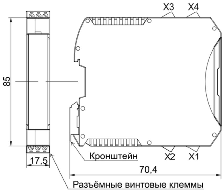
Рисунок 8 – Габаритные размеры преобразователя
