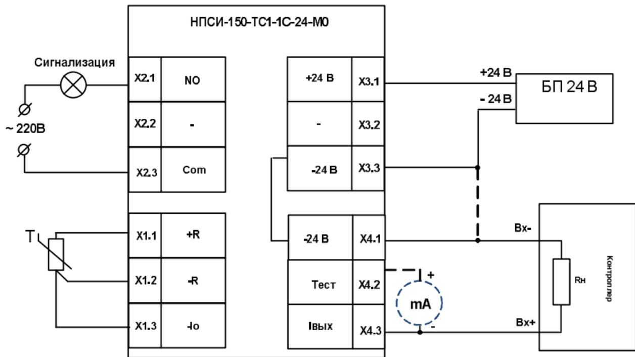
Рисунок 9 – Схема подключения преобразователей НПСИ-150-ТС1-1С-24-М0
