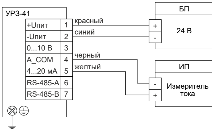
Рисунок Б.5 - Схема электрическая подключений УРЗ-41 (исполнение с кабельными вводами) с унифицированным выходным сигналом от 4 до 20 мА
