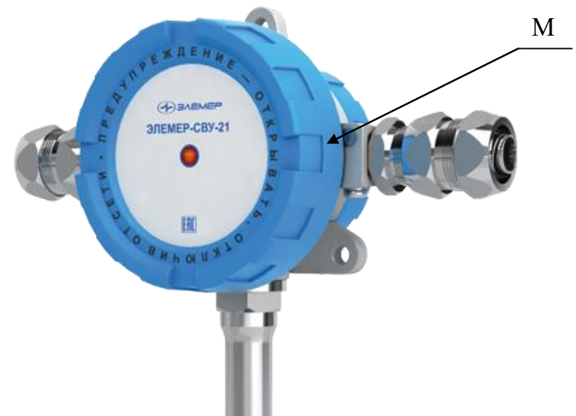
Рисунок 3.1 – Место приложения магнита при тестировании сигнализаторов (М)
