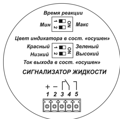
Рисунок 2.5 – DIP-переключатели на плате сигнализаторов с кодами при заказе «D» и «R»
