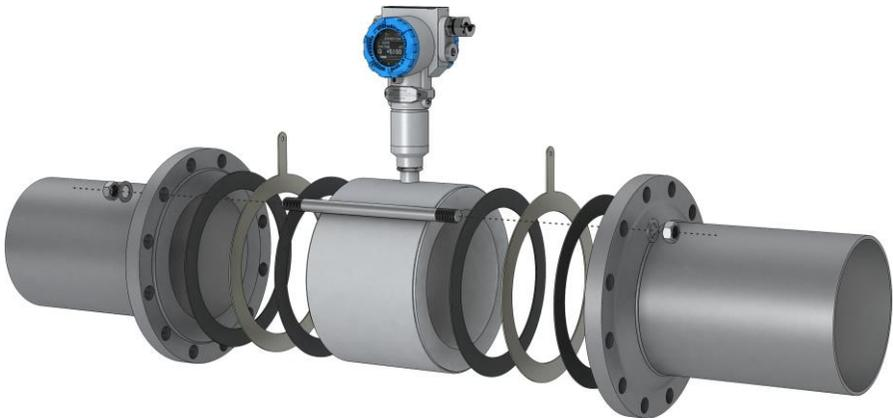
Рисунок 3.17 – Монтаж в трубопровод бесфланцевого (сэндвич) расходомера с кольцами заземления
