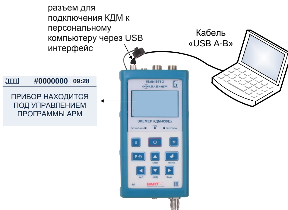
Рисунок 2.46 – Подключение КДМ к ПК (с использованием кабеля «USB A-B»)
