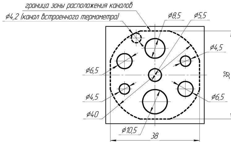
Рисунок А.1 — Термостатирующий блок ЭЛЕМЕР-КТ-150К/М1 со стандартным набором каналов (СТБ)
