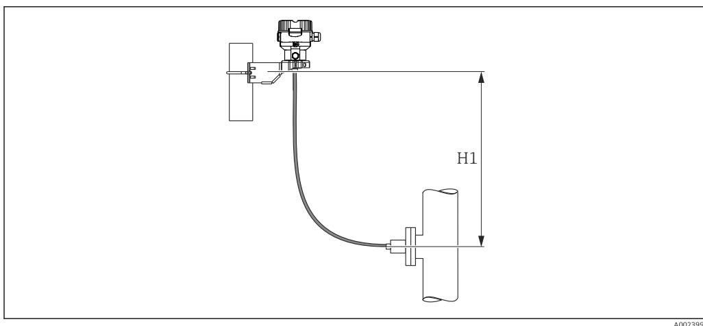
Максимальный разнос по высоте зависит от плотности заполняющего масла и наименьшего допустимого давления, действующего на разделительную диафрагму (пустой резервуар); см. приведенный ниже рисунок. На рисунке приведен максимальный разнос по высоте для установки над нижней разделительной диафрагмой в случае работы с вакуумом.
