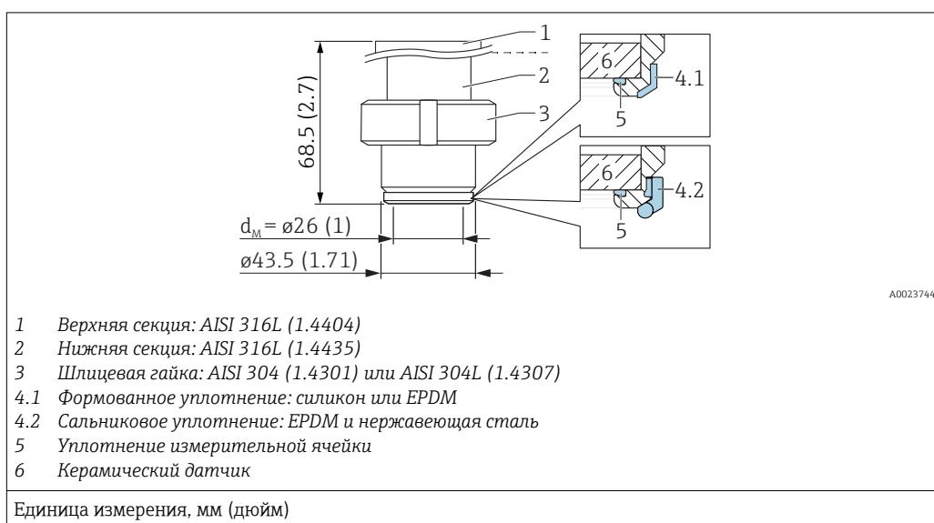
Шероховатость поверхности, соприкасающейся с технологической средой, составляет  $R_a < 0,76$  мкм (30 микродюймов).
