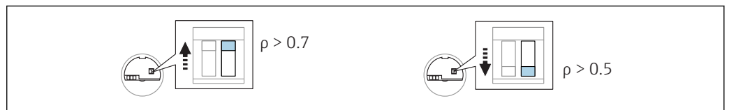
54 Положение переключателя плотности на электронной вставке
