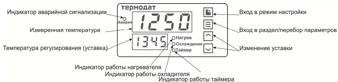
Рисунок 6 – Описание индикаторов и кнопок управления прибора 12К6-D8-H/...
