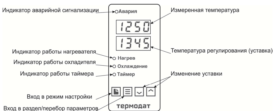
Рисунок 5 – Описание индикаторов и кнопок управления прибора 12К6-D8/...
