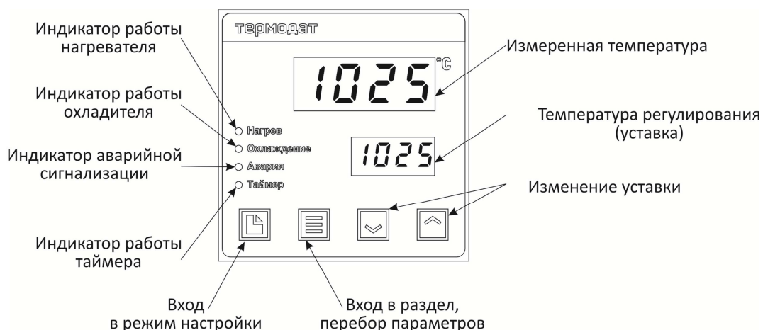
Рисунок 4 – Описание индикаторов и кнопок управления прибора 12К6-D4/...
