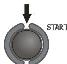
Для начала измерения нажмите клавишу **START**. Некоторые измерения могут привести к выключению УЗО. Для измерения следующих параметров достаточно привести УЗО в рабочий режим.
