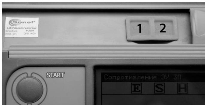
Расположение разъемов зарядки (1) и подключение компьютера USB (2)
