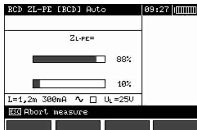
Процесс выполнения обозначен индикаторами выполнения: нижний – полный цикл; верхний – измерение  $Z_{L-PE}$  **RCD** и  $I_A$ .
