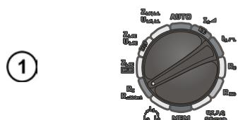
Установите поворотный переключатель в режим  $R_x R_{\pm 200 \text{ mA}}$ .
