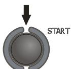
Нажмите клавишу **START** для повторного измерения без отключения измерительных проводников.
