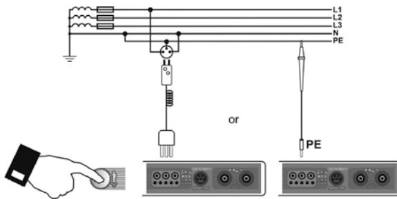
Подключите измеритель согласно схеме представленной на рисунке, приложите палец к электроду прикосновения на 1 секунду. Если на PE проводнике будет обнаружено напряжение, на дисплее отобразится сообщение **PE!** (ошибка подключения, на PE проводнике обнаружено опасное напряжение). Данное сообщение будет сопровождаться продолжительным звуковым сигналом. Данная функция активна во всех режимах, связанных с измерением параметров УЗО или петли короткого замыкания.
