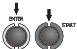
Для блокировки клавиши **START** нажмите ее и удерживайте до звукового сигнала (3-5 сек). После нажмите клавишу **ENTER** и отпустите обе клавиши. Для остановки измерения нажмите **START**.
