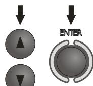
Выберите  $R_{CONT} \pm 200 \text{ mA}$ , используя клавиши  $\blacktriangle$  и  $\blacktriangledown$ , и подтвердите выбор, нажатием клавиши **ENTER**.
