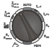
Установите поворотный переключатель в режим  $Z_{L-N,L-L}$  /  $U_{L-N,L-L}$
