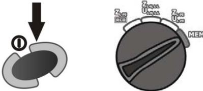
Включите измеритель. Установите поворотный переключатель в положение **MEM**.
