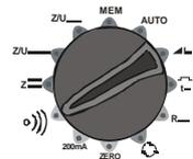
Включите измеритель. Установите поворотный переключатель в режим  $\Omega$ .
