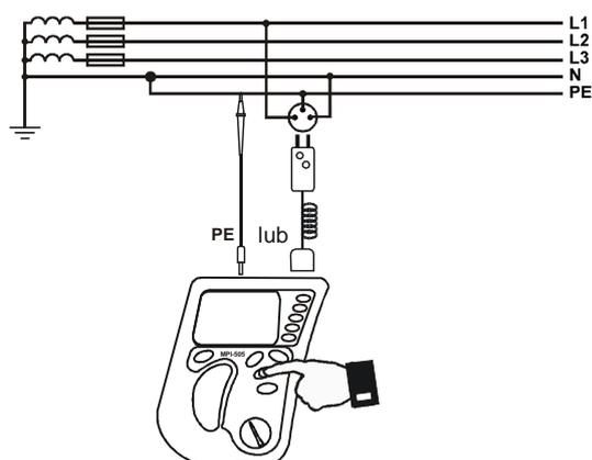
Подключите измеритель согласно схеме представленной на рисунке. Прикоснитесь пальцем к электроду прикосновения, расположенному на корпусе измерителя, и удерживайте его 1-2 секунды. Если прибор обнаружит опасное напряжение на проводнике PE, на дисплее отобразится символ PE (неправильное подключение проводника, замыкание), а также будет сопровождаться непрерывным звуковым сигналом.
