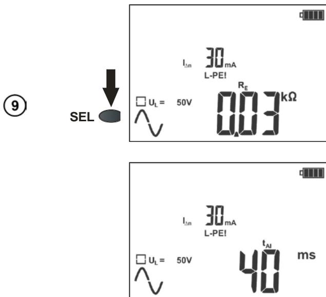
Время  $t_{A1}$  протекания тока срабатывания  $I_{A}$
