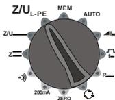
Включите измеритель. Установите поворотный переключатель в режим **Z/U<sub>L-PE</sub>**.
