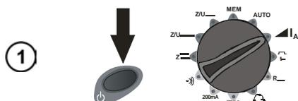
Включите измеритель. Установите поворотный переключатель в режим  $I_A$ .
