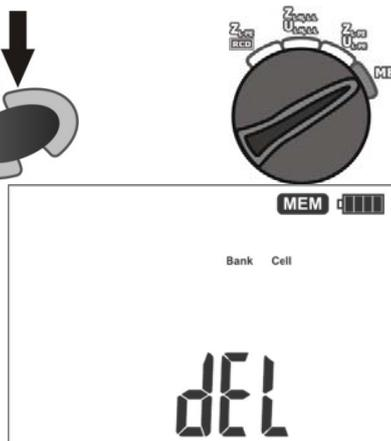
Включите измеритель. Установите поворотный переключатель в положение **MEM**.
