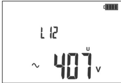
После нескольких секунд или нажатия клавиши **ESC**, прибор вернется в режим отображения последовательности чередования фаз
