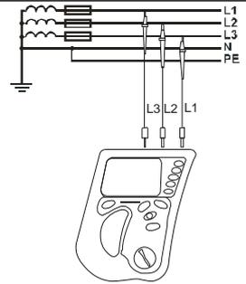
Подключите измеритель согласно схеме
