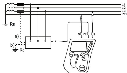
Остальные шаги совпадают с измерением параметров петли короткого замыкания L-PE
