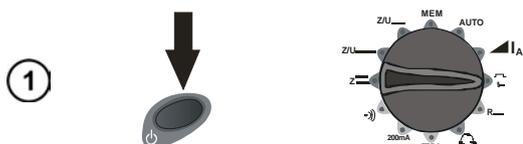
Включите измеритель. Установите поворотный переключатель в режим  $t_A$ .
