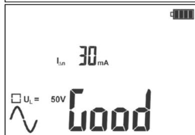
На основании проведенных измерений прибор делает заключение: **Good** - рабочее УЗО или **bad** - нерабочее.
