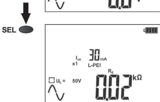
Сопротивление защитного заземления  $R_E$
