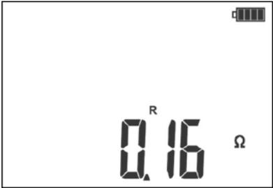
Результат измерения определяется как среднее арифметическое двух значений, полученных при протекании тока в разных направлениях.
