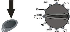
Включите измеритель. Установите поворотный переключатель в режим  $Z_{L-PE}^{RCD}$ .
