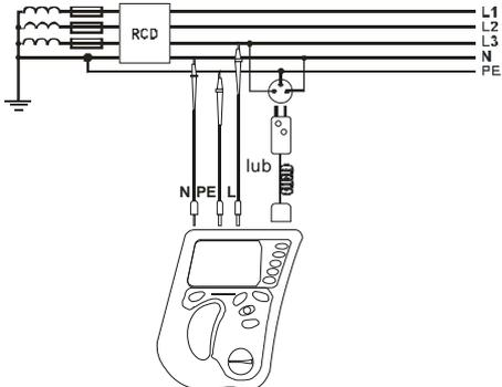
Подключите измеритель согласно схеме
