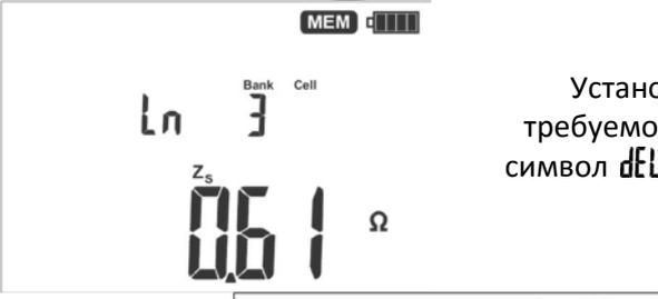
Установите нулевой номер ячейки в требуемом банке. На дисплее отобразится символ **dEL**, обозначающий удаление данных памяти.
