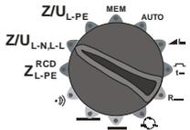
Установите поворотный переключатель в режим измерения параметров петли короткого замыкания
