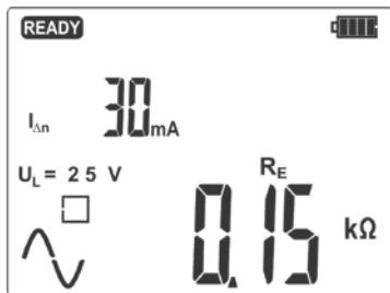
Сопротивление защитного заземления  $R_E$
