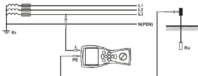
Для систем TN-C-S, когда измеряемая линия является также дополнительным источником энергии, необходимо производить отключение PE и N проводников. Невыполнение данного условия может привести к неправильному измерению. Схема измерения:
