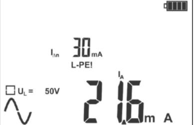
Главный результат измерения - ток отключения УЗО  $I_A$ .
