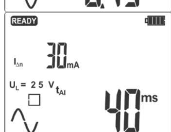
Время  $t_{AI}$  протекания тока срабатывания  $I_A$
