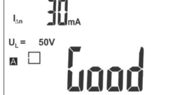
На основании проведенных измерений прибор делает заключение: **Good** - рабочее УЗО или **Bad** - нерабочее.
