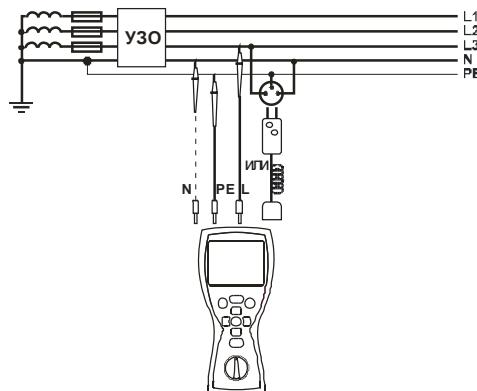
Подключите измеритель согласно схеме
