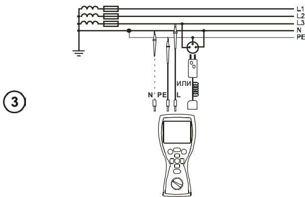
Подключите измеритель согласно схеме
