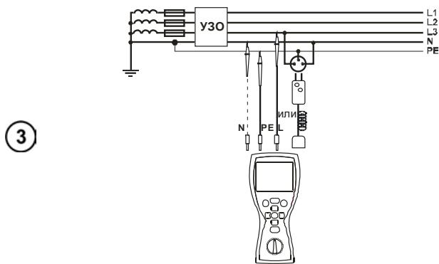
Подключите измеритель согласно схеме
