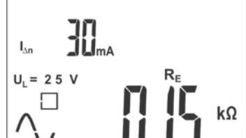
Сопротивление защитного заземления  $R_E$
