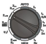
Установите поворотный переключатель в режим измерения параметров петли короткого замыкания
