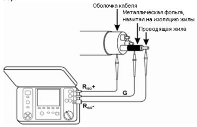
Так же поступают при измерении сопротивления изоляции между двумя жилами кабеля, присоединяя к разъему **G** остальные жилы, не участвующие в измерении.
