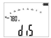
• В случае силовых электрических кабелей, нужно измерять сопротивление изоляции между каждой жилой и остальными, накоротко замкнутыми и заземленными (рисунок ниже).
