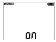
На дисплее появится надпись шожно оп свидетельствующая о выполнении калибровки измерительных проводов, затем прибор переходит в режим измерения.
