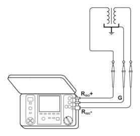
• при измерении сопротивления изоляции между одной из жил кабеля и оболочкой кабеля, влияние поверхностных токов (важно в сложных погодных условиях) устраняется соединением кусочка металлической фольги, навитого на изоляцию измеряемой жилы, с разъемом **G** прибора:
