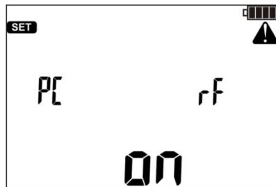
На дисплее отобразится режим передачи данных
