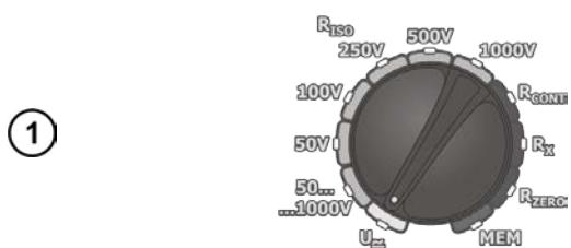
Установите поворотный переключатель в режим  $U_{\text{AC}}$
