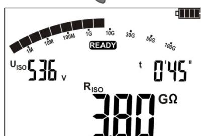
После окончания измерения на дисплее отобразиться величина измерения сопротивления электроизоляции.
