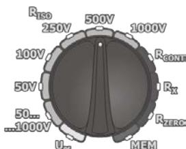
Установите поворотный переключатель в режим  $R_{iso}$  для одного из стандартных напряжений или в положение **50...1000V** с возможностью установки произвольной величины измерительного напряжения с шагом 10 В в заданном диапазоне.
