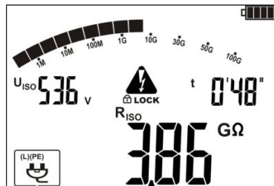
Прибор проведет измерение для выбранных проводников в следующем порядке: L-N, L-PE, N-PE.
