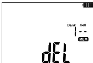
Вместо номера ячейки отобразится символ **dEL** подтверждающей удаление данных
