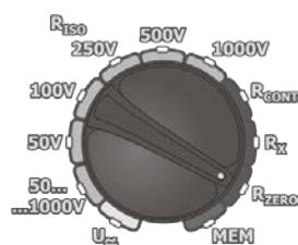
Установите поворотный переключатель в режим  $R_{ZERO}$
