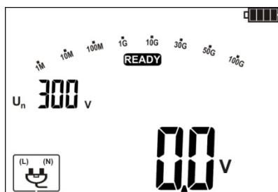
После подключения адаптера к измерителю, на дисплее отобразиться соответствующий символ.
