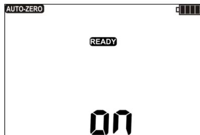
**AUTO-ZERO** и **ON** отображены на дисплее, подтверждающие завершение процесса компенсации (калибровки) сопротивления измерительных проводников.
