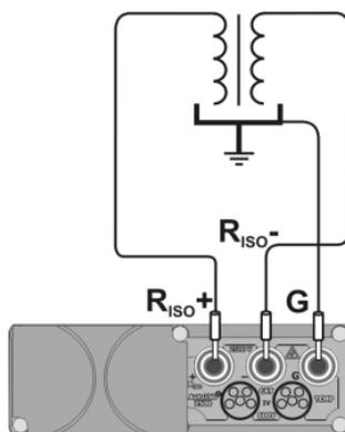
При измерении сопротивления между жилой кабеля и экраном, влияние поверхностных токов (особое влияние оказывают при сложных погодных условиях) исключают присоединением
