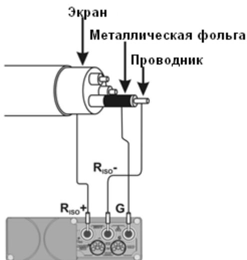
Таким же способом подключается разъем **G** при измерение сопротивления между двумя жилами к третьей, не участвующей в процессе измерения.
