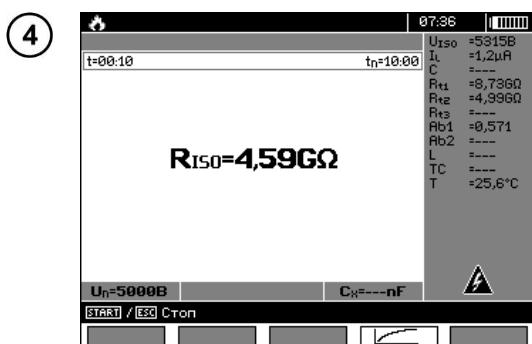
Внешний вид экрана в процессе измерения. Как во время измерения, так и после его завершения существует возможность переключения между экраном с результатами и экраном с графиком с помощью клавиши F4
