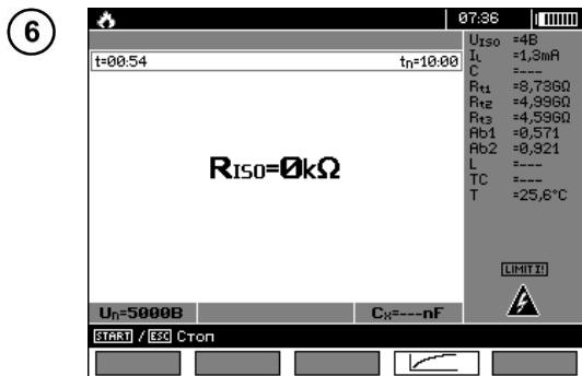
После завершения измерения считайте результат. Внешний вид экрана после измерения с пробоем изоляции(дожигом).
