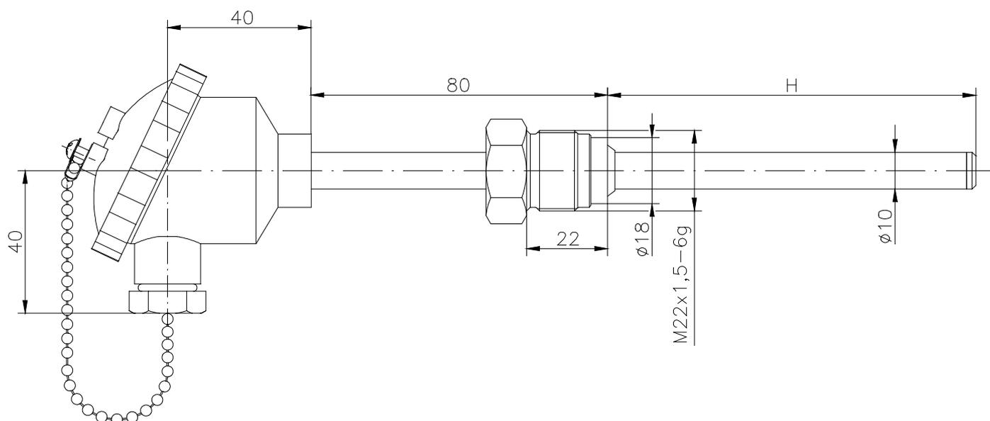
Корпус снабжен подвижным штуцером, содержит коммутационную головку с винтовыми контактами для подсоединения удлинительного провода.
