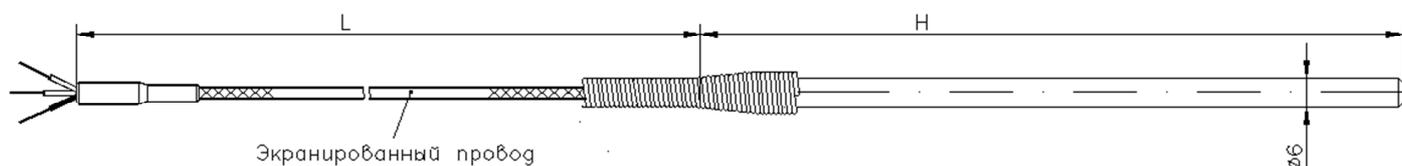
Корпус термосопротивления выполнен из нержавеющей стали 12Х18Н10Т.
