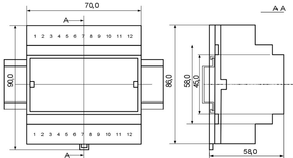
Рисунок 5.1 – Габаритные и присоединительные размеры модуля
