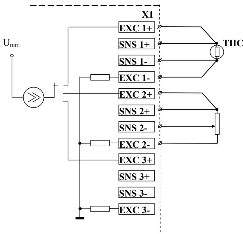
Рисунок 5.2 – Подключение датчиков к измерительным входам
