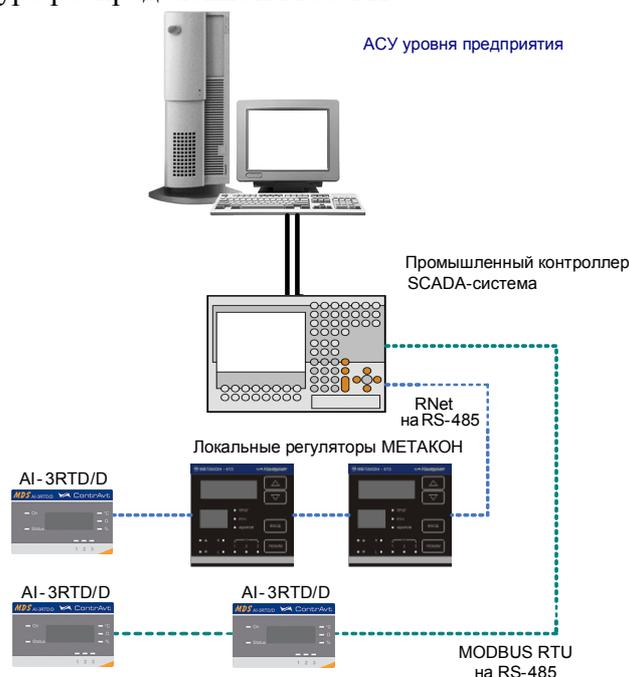
Модули серии MDS обеспечивают периферийный ввод-вывод аналоговых и дискретных сигналов. Модули MDS AI-3RTD и AI-3RTD/D входят в состав серии MDS и имеют 3 независимых канала измерения аналоговых сигналов термопреобразователей сопротивления и потенциометрических датчиков, осуществляют передачу данных в управляющий компьютер (контроллер).
