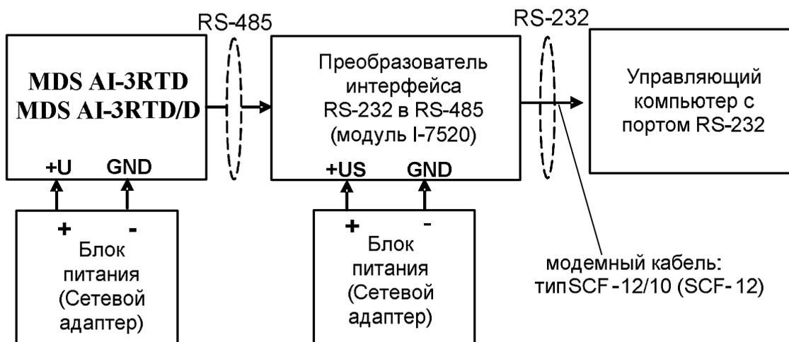
Рисунок 6.1 – Подключение модулей в режиме работа
