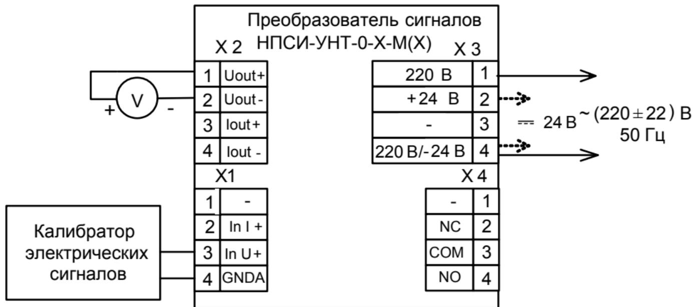
Рисунок А.6.3.1.1 – Подключение преобразователя мод. НПСИ-УНТ-0-Х-М0, НПСИ-УНТ-0-Х- М(0/ВС/М) для проведения поверки: вход напряжение от 0 до 10 В, выход унифицированный сигнал напряжения от 0 до 10 В
