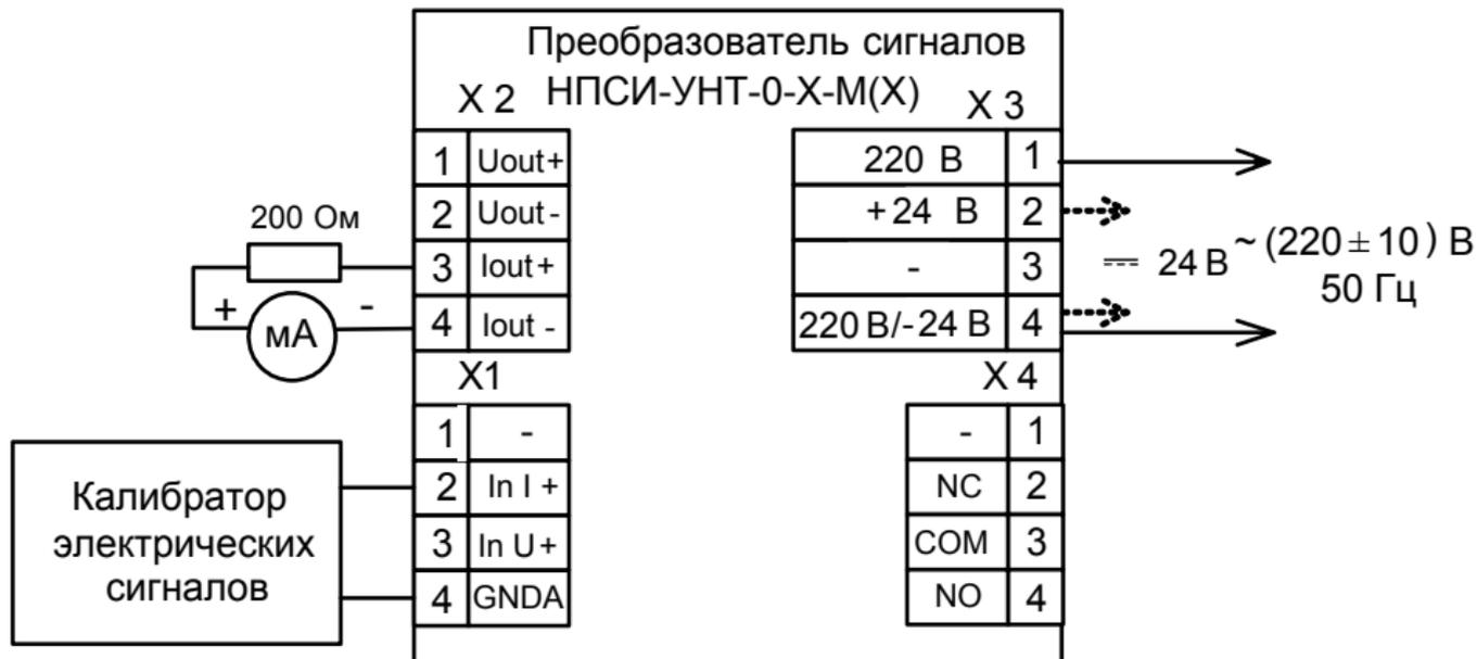
Рисунок А.6.3.3.1 – Подключение преобразователя мод. НПСИ-УНТ-0-Х-М0, НПСИ-УНТ-0-Х- М(0/ВС/М) для проведения поверки: вход постоянный ток от 0 до 20 мА, выход унифицированный сигнал постоянного тока от 0 до 20 мА
