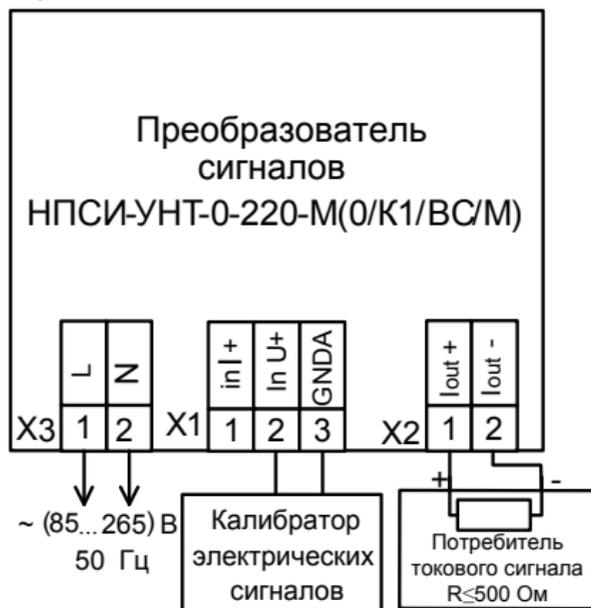
Рисунок А.6.3.1.2 – Подключение преобразователя мод. НПСИ-УНТ-0-220-М(0/К1/ВС/М) для проведения поверки: вход напряжение от 0 до 10 В, выход унифицированный сигнал постоянного тока от 0 до 20 мА
