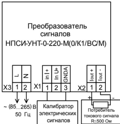
Рисунок А.6.3.3.2 – Подключение преобразователя модификации НПСИ-УНТ-0-220-М(0/К1/ВС/М) для проведения поверки: вход – постоянный ток от 0 до 20 мА, выход – унифицированный сигнал постоянного тока от 0 до 20 мА
