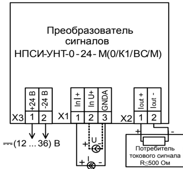
Рисунок 13 – Электрическая схема подключения преобразователя
