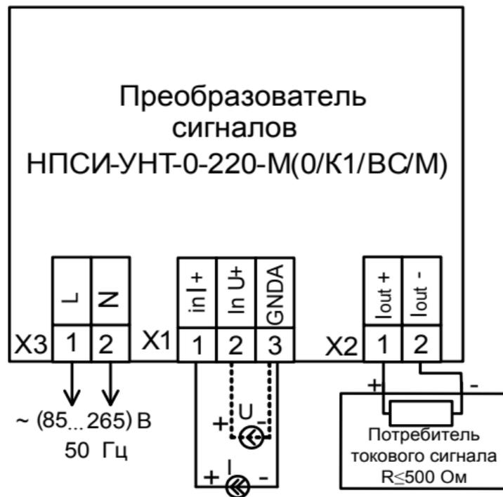
Рисунок 12 – Электрическая схема подключения преобразователя
