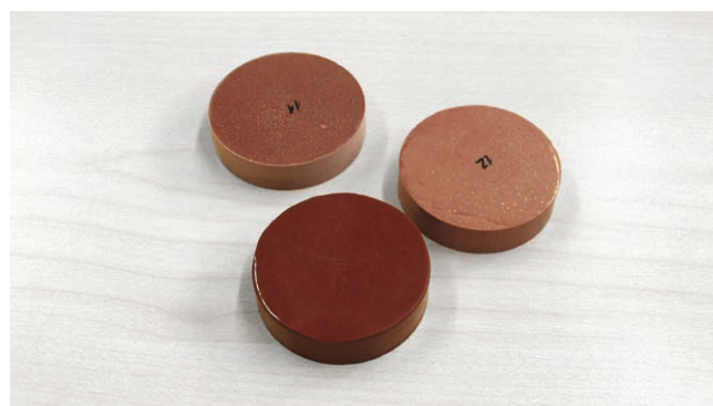
Изменение цвета образцов изоляционной смолы в зависимости от продуктов разложения в элегазе SF 6
