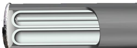
Конструкция рабочей зоны термопреобразователей ТППТ(ТПРТ) 22.06 с двумя внутренними защитными чехлами, один из которых предназначен для установки контрольной термопары.
