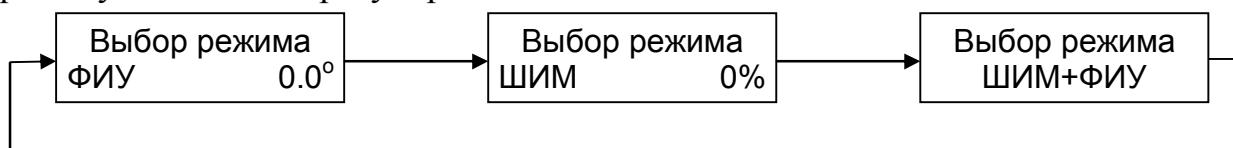
Подтверждение выбора и переход к выбору входа управления производится нажатием кнопки □, а выбор осуществляется опять же кнопками  $\nabla$  и  $\Delta$ . В зависимости от выбранного метода регулирования будет предложено выбрать либо управление для ФИУ, либо для ШИМ. В случае выбора метода ШИМ+ФИУ нужно будет выбрать соответствующий вход управления для каждого из этих методов.
