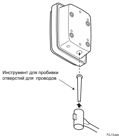
Рисунок 2.13. Как выбить отверстие для электропроводов
