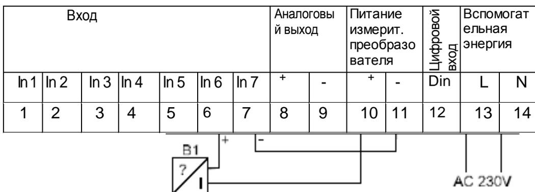
Измерение сигнала напряжения (5 В или 10 В) от 3-проводного измерительного преобразователя осуществляется с использованием следующих функций:
