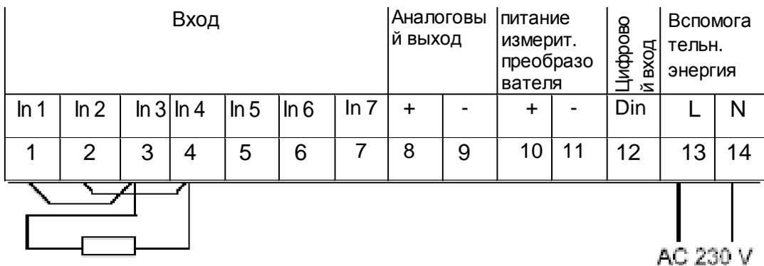
Измерение резистивного термометра (например, РТ100) или сопротивления в 3-проводной технологии; вспомогательная энергия DC 24 В
