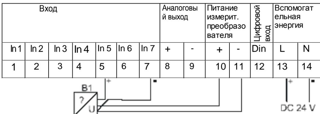
Измерение сигнала напряжения (< 2,5 В) от 3-проводного измерительного преобразователя осуществляется с использованием следующих функций:
