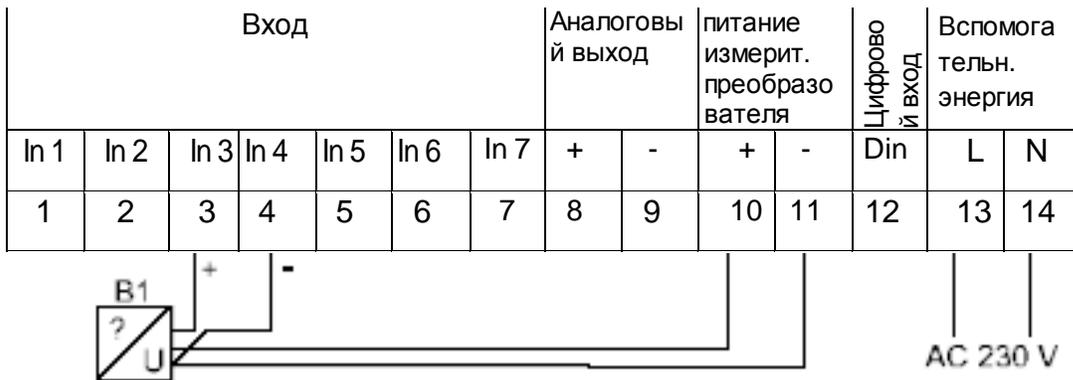
Измерение резистивного термометра (например, РТ100) или сопротивления в 2-проводной технологии; вспомогательная энергия AC 230 В
