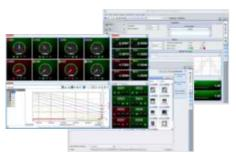
Программное обеспечение GA10 предназначено для сбора и мониторинга больших объемов данных от регистраторов, контроллеров и других измерительных устройств Yokogawa, а также от любых устройств, поддерживающих протокол Modbus.
