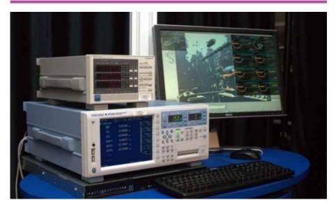
Измерители мощности WT3000 точно измеряют характеристики электрической мощности приборов, которые генерируют, преобразуют или потребляют электричество.
