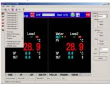
Программа CXOperator предназначена для работы со станциями CX2000 и позволяет управлять началом/окончанием записи измерений, задавать параметры для управления контурами, а также осуществлять мониторинг экранов регистрации/управления. Рабочие экраны, такие как экран тренда, управления и программы могут быть переключены удаленно. Параметры, связанные с записью данных тренда, управлением контурами, такие как SP, OUT, режим работы, могут быть назначены удаленно.
