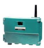
Многоканальный беспроводной преобразователь температуры YTMX580 имеет 8 универсальных измерительных каналов и предназначен для преобразования сигналов от термопар и термометров сопротивления, а также сигналов постоянного тока, напряжения и сопротивления в беспроводной сигнал в соответствии со стандартом ISA 100.11а для передачи данных удаленным системам регистрации и управления.
