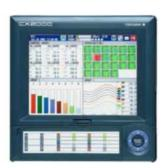
Станции СX2000 сочетают в себе функции регистраторов и контроллеров, позволяя одновременно осуществлять управление процессом с помощью встроенных контуров ПИД-регулирования и регистрацию данных.
