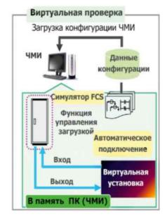
Станция инженера (ENG и HIS) имеет виртуальную функцию тестирования, которая позволяет осуществлять тестирование алгоритмов управления системы на одном ПК. Виртуальная среда станции FCS и станции
