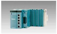
FCN-RTU – автономный контроллер, обеспечивающий надежное управление для географически распределенных объектов, где требуется низкое энергопотребление и работа в неблагоприятных условиях.
