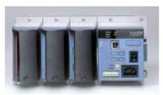
Настройка MX100, а также визуализация и обработка данных осуществляются посредством ПК с помощью ПО MXSTANDARD (поставляется в комплекте). Работа с МW100 также может осуществляться посредством ПК с помощью обычного web-браузера (например, Internet Explorer).
