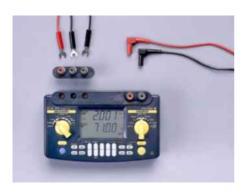
Портативные калибраторы CA51/71 измеряют и генерируют напряжение постоянного тока, постоянный ток, сопротивление, сигналы от термопар и термосопротивлений, частоту, импульс; а также измеряют напряжение переменного тока.
