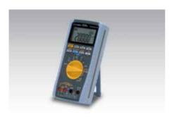
Мультиметр-калибратор для технологических процессов CA450 объединяет в себе функции цифрового мультиметра и генератора токовой петли 4–20 мА.
