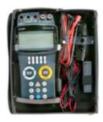
Портативный калибратор CA150 измеряет и генерирует напряжение постоянного тока, постоянный ток, сопротивление, сигналы от термопар и термосопротивлений, частоту, импульс.
