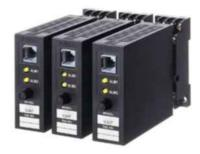
Конфигурация устройств серии JUXTA осуществляется посредством ПК с помощью программного обеспечения VJ77. Преобразователи выполнены в едином конструктивном исполнении и могут монтироваться как индивидуально, так и на монтажной плате VJCE, позволяющей объединить до 16 устройств
