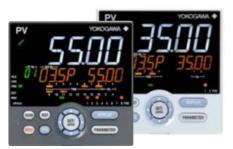
Программные контроллеры серии UTAdvanced имеют возможность задания управляющей последовательности для реализации сложных температурных режимов, а также способны решать локальные задачи управления и регулирования.
