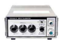
Калибратор электромагнитных расходомеров AM012 разработан специально для поверки и калибровки электромагнитных расходомеров компании YOKOGAWA. Представляет собой имитатор первичного преобразователя электромагнитного расходомера.
