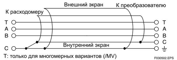
Рис.3.4 Устройство сигнального кабеля разнесенного типа
