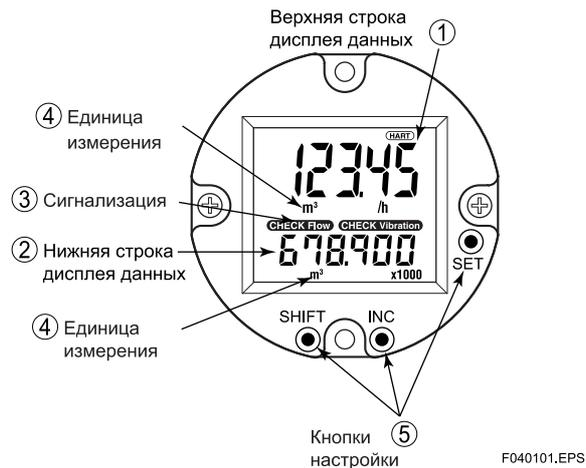
Рис. 4.1 Устройство дисплея
