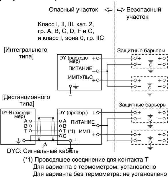
Электрические параметры вихревого расходомера (DY) и вихревого преобразователя потока (DYA).
