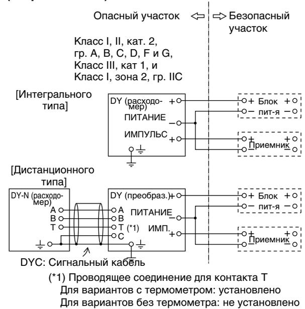
Параметры проводящих соединений, обеспечивающие нестимулирующие свойства для вихревого расходомера (DY) и вихревого преобразователя потока (DYA).
