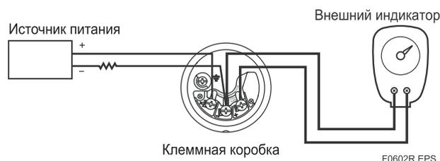
Рисунок 6.2 Подсоединение внешнего индикатора
