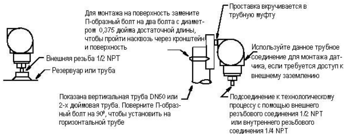
Рис. 10. Монтаж датчиков давления IAP10, IGP10, IGP25 и IGP50
