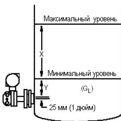
Рис.14. Датчик (IDP10 или IGP20), подключенный к открытому резервуару
