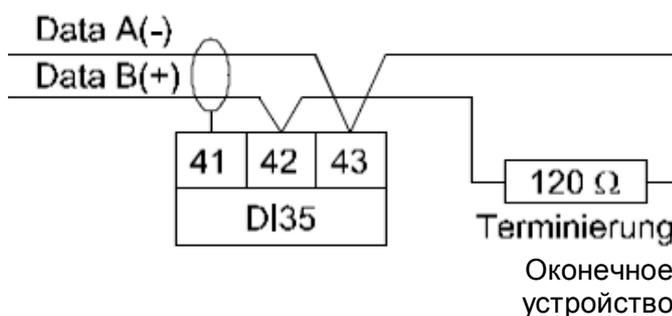
Поставляемые интерфейсы подразделяются соответственно на имеющие гальваническую развязку и не имеющие гальваническую развязку варианты исполнения. Если интерфейс не имеет гальванической развязки, то он связан с потенциалом входа измерительной системы.
