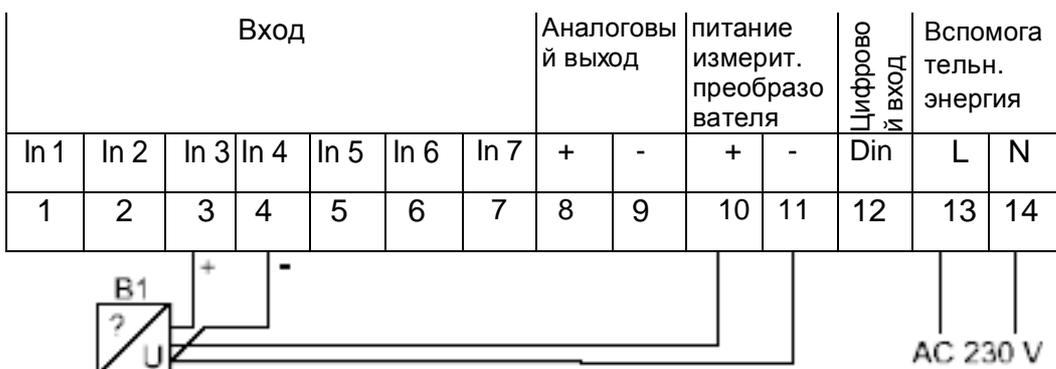
Измерение резистивного термометра (например, РТ100) или сопротивления в 2-проводной технологии;
