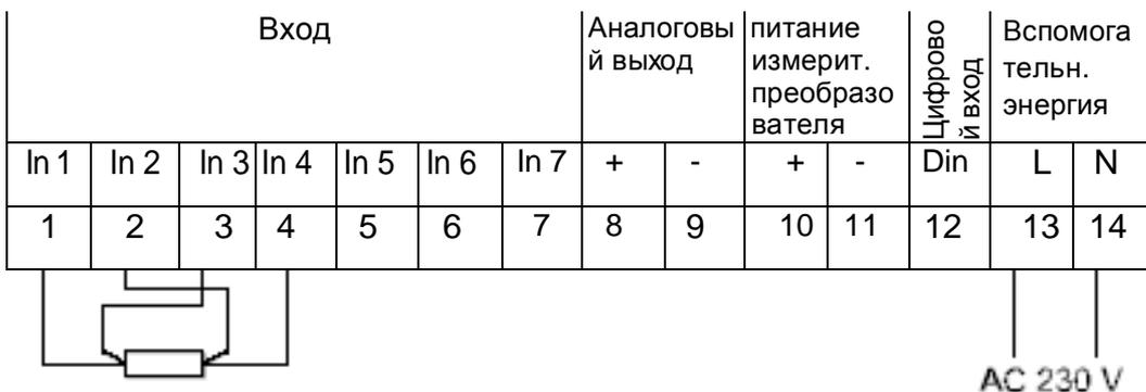
Измерение термоэлемента; подключение аналогового выхода; подключение цифрового входа к питанию измерительного преобразователя; вспомогательная энергия AC 230 В
