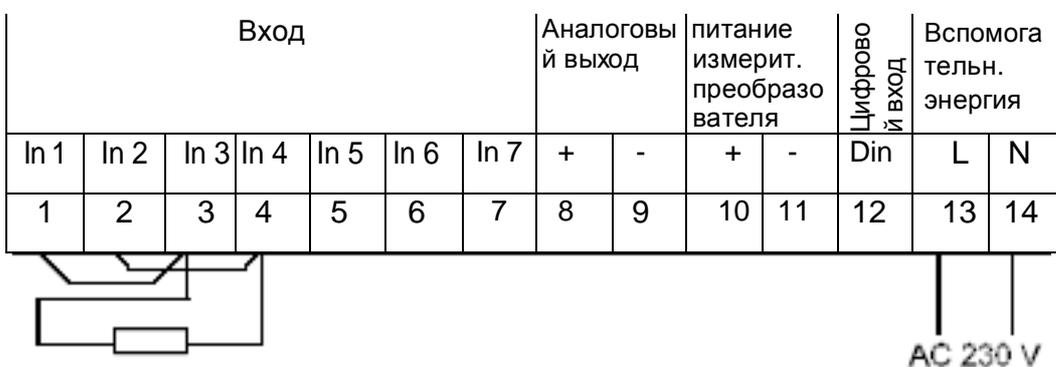
Измерение резистивного термометра (например, РТ100) или сопротивления в 3-проводной технологии;
