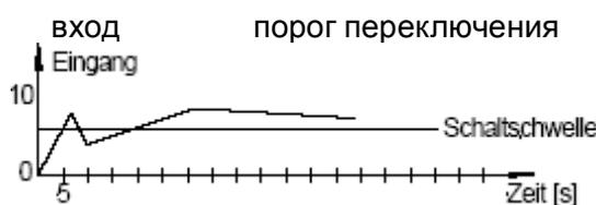
Задержка отключения действует аналогичным же образом, но удерживает точку переключения включенной в течение более длительного, предварительно устанавливаемого отрезка времени
