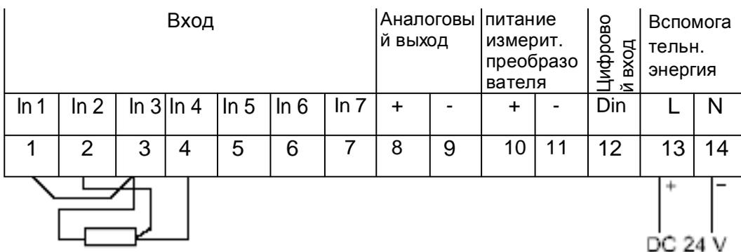
Измерение резистивного термометра (например, PT100) или сопротивления в 4-проводной технологии; вспомогательная энергия AC 230 В
