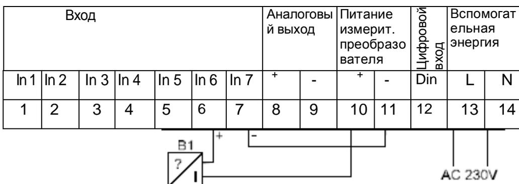
Измерение сигнала напряжения (5 В или 10 В) от 3-проводного измерительного преобразователя осуществляется с использованием следующих функций:
