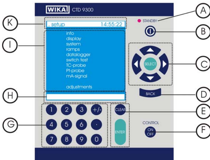
Рисунок 2: Пользовательский интерфейс CTD 9300
