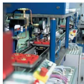
Полностью автоматизированное производство стандартных манометров
