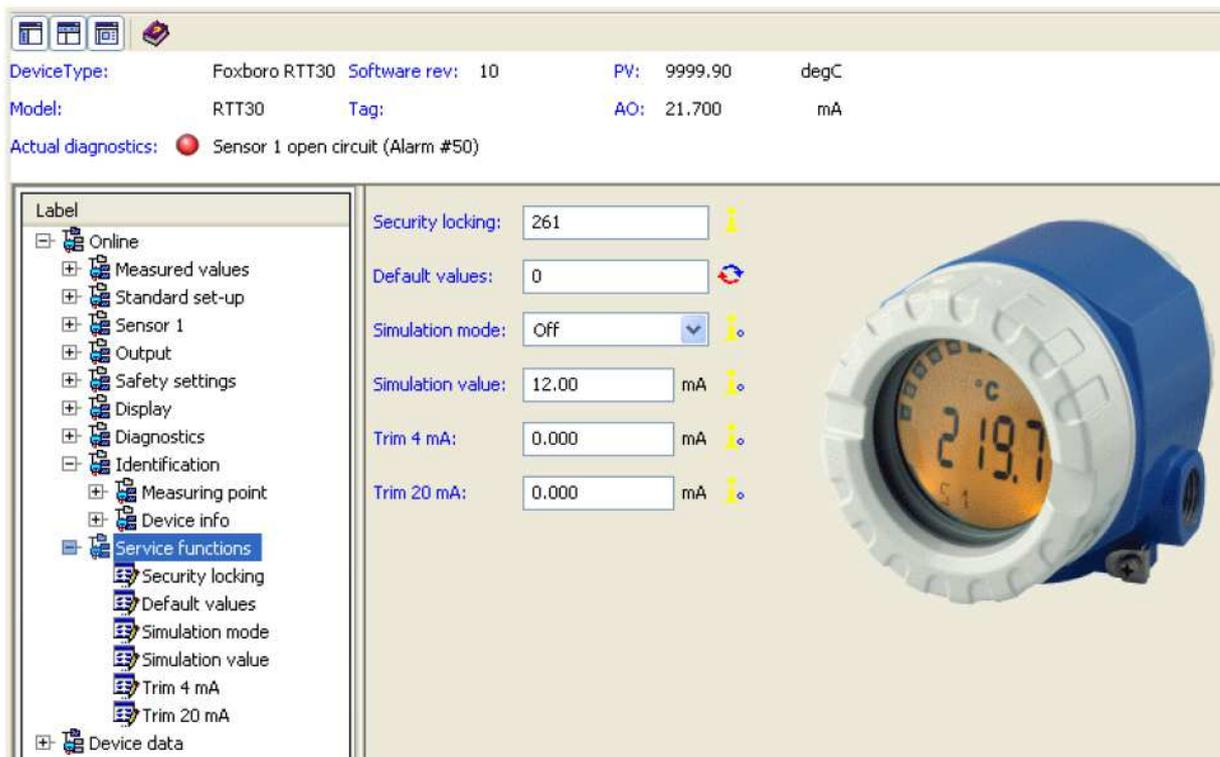
**Рис. 22. Пример экрана Service преобразователя температуры модели RTT30**
