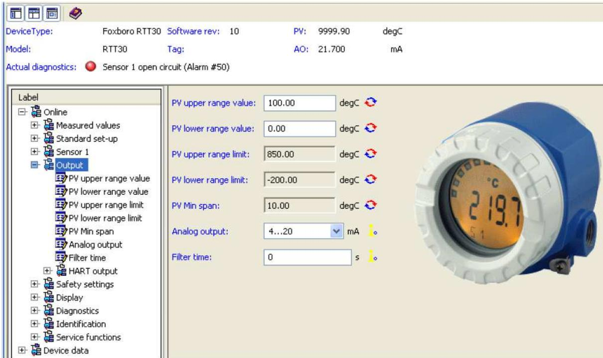
**Рис. 16. Пример экрана Output преобразователя температуры модели RTT30**
