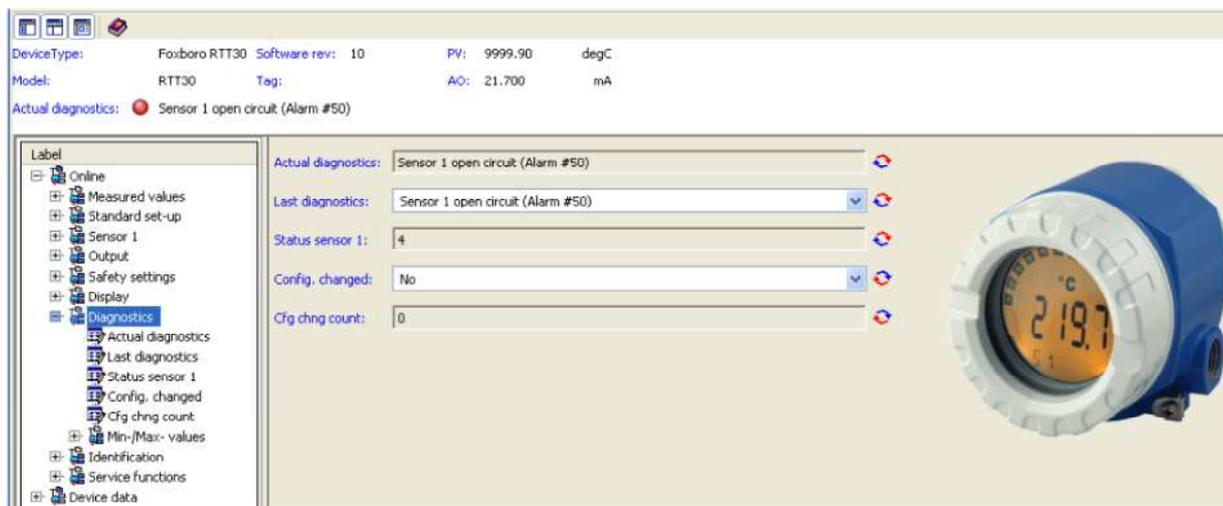
**Рис. 19. Пример экрана Diagnostics преобразователя температуры модели RTT30**
