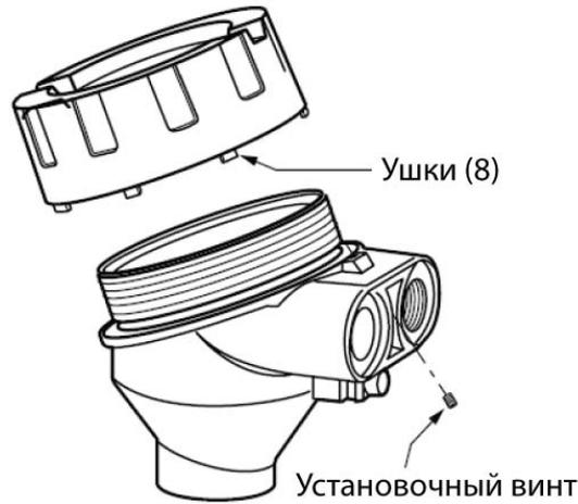
*Рис. 8. Стопор крышки взрывозащищенной соединительной головки*
