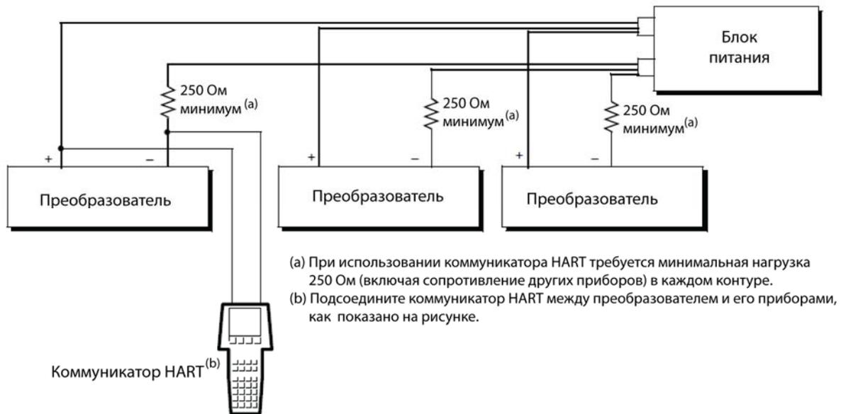
Рис. 13. Подключение нескольких преобразователей к общему блоку питания
