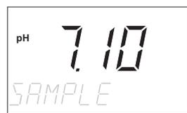
Преобразователь PH202 продолжает выполнять измерение / управление. Мигает надпись **SAMPLE**, указывающая, что данные сохранены и ожидают ввода анализируемого значения.
