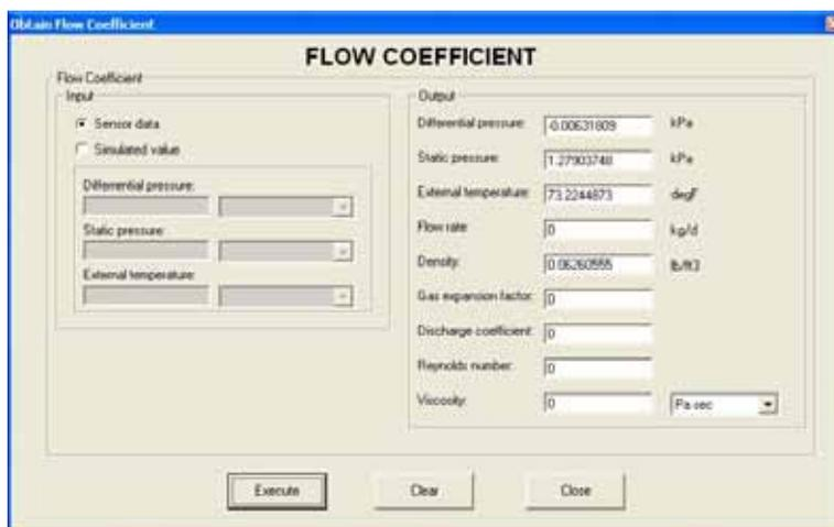
Выполните моделирование расхода для проверки (подтверждения) сконфигурированных параметров расхода. Введите значения дифференциального давления, статического давления и температуры и проверьте, чтобы получился требуемый расход.
