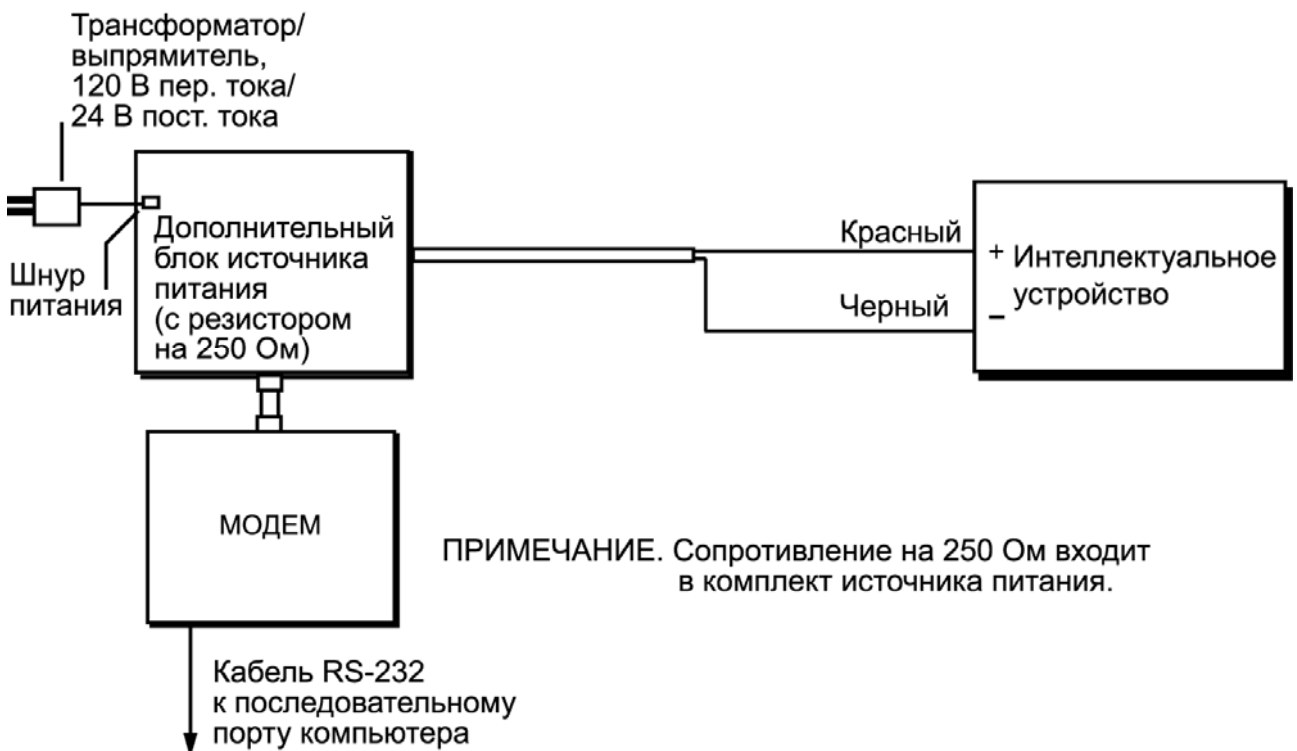
Рисунок 4. Устройство FoxCom с дополнительным источником питания.
