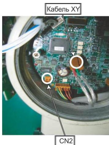
**Рисунок 157. Демонтаж кабеля X-Y**
