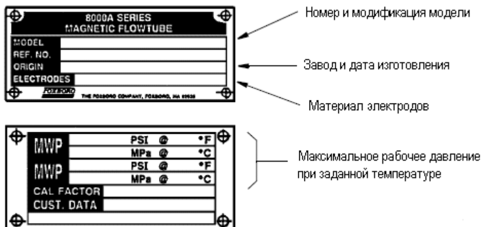
Рисунок 11. Пример идентификации магнитной расходомерной трубки серии 8000
