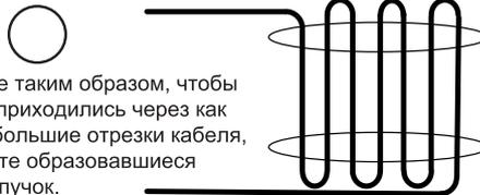
Сложите таким образом, чтобы изгибы приходились через как можно большие отрезки кабеля, и свяжите образовавшиеся витки в пучок.
