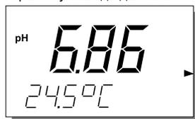
На дисплее начинает мигать значение рН. Прибор находится в состоянии ожидания стабилизации измерения.
