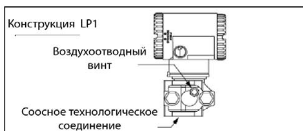
Рисунок 16. Вертикальный монтаж – Вентиляция камеры сенсора
