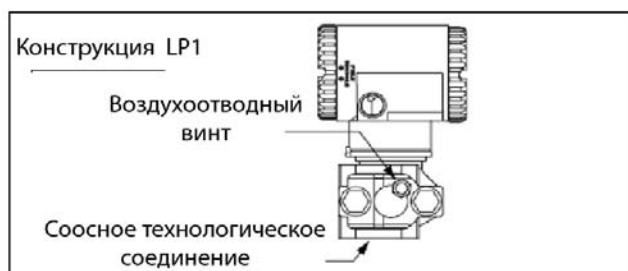
Рисунок 16. Вертикальный монтаж – Вентиляция камеры сенсора
