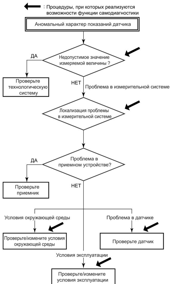
Рисунок 8.5.1 Схема последовательности операций по самодиагностике и обнаружению неисправностей
