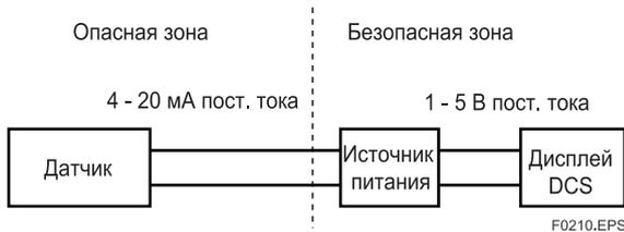
Рисунок 2.3 Пример использования DCS (Распределенной системы управления)
