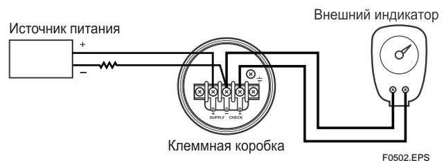
Рисунок 5.3.2. Подсоединение внешнего индикатора
