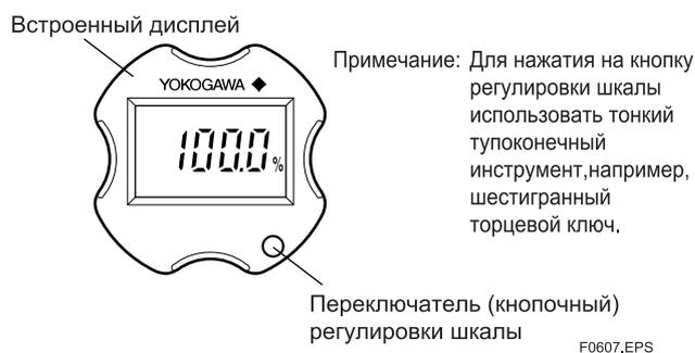
Рисунок 6.5.1 Переключатель диапазонов
