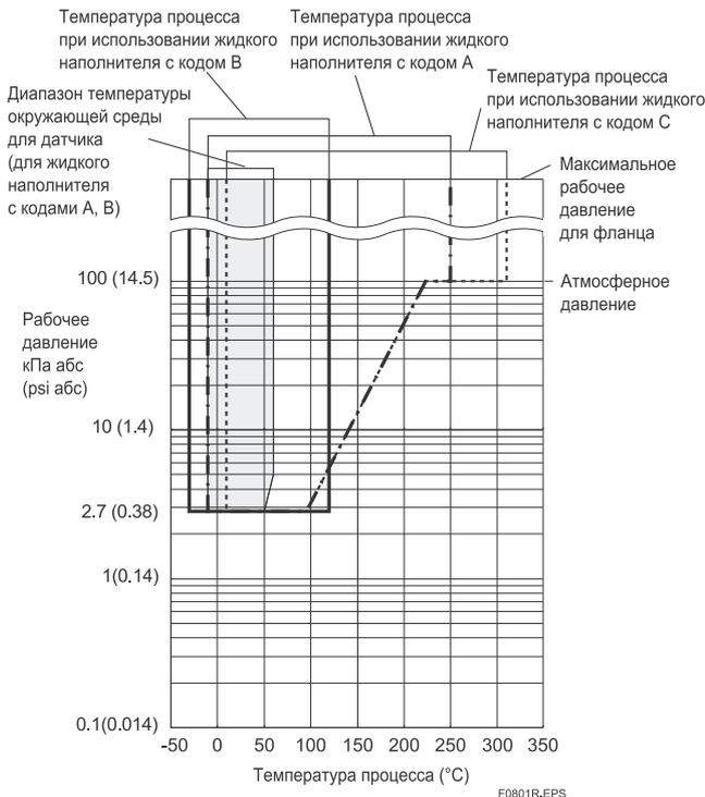
**Рисунок 8.1** Рабочее давление и температура процесса (Жидкий наполнитель: силиконовое масло для общего и высокотемпературного применения)
