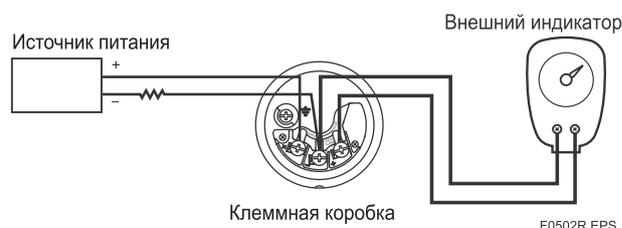
Рисунок 5.2 Подсоединение внешнего индикатора
