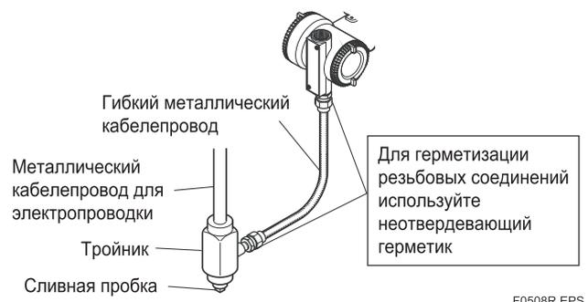
Рисунок 5.8 Типичный пример проводки с использованием гибкого металлического кабелепровода
