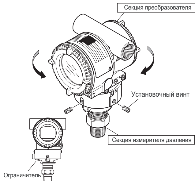
Рисунок 4.4 Вращение секции преобразователя
