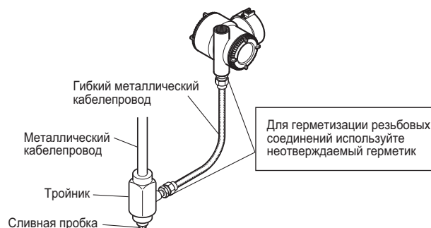
Рисунок 6.8 Типичный пример проводки с использованием гибкого металлического кабелепровода
