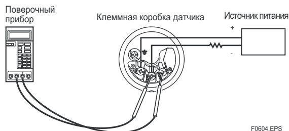
Рисунок 6.4 Подсоединение поверочного прибора
