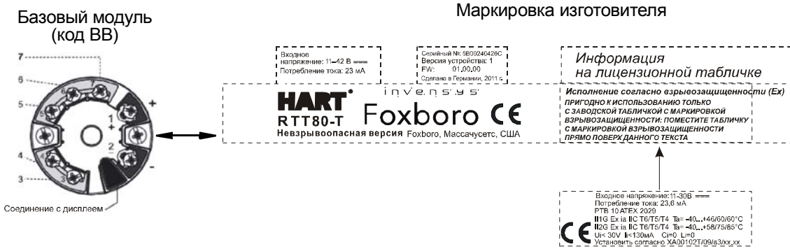
Рисунок 1. Типовая идентифицирующая этикетка на корпусе и код монтажа датчика ВВ
