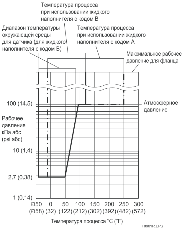
Рисунок 9.1 Рабочее давление и температура процесса (Жидкий наполнитель: силиконовое масло для общего и высокотемпературного применения)
