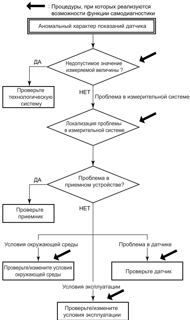
Рисунок 8.5 Схема последовательности операций по самодиагностике и обнаружению неисправностей
