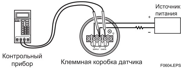
Рис. 6.3.4 Подсоединение контрольного прибора
