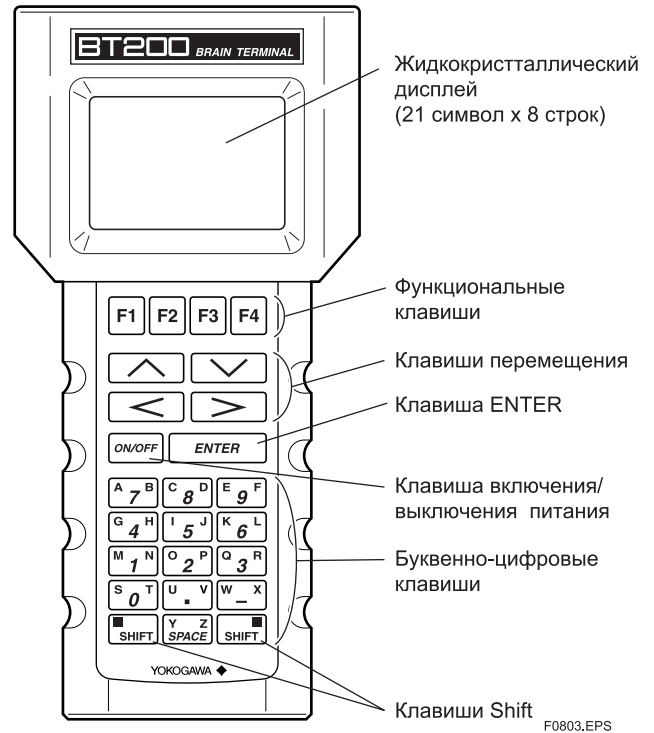
Рис. 8.2.1а Размещение клавиатуры прибора BT200
