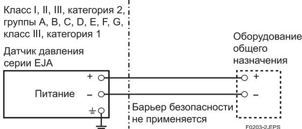
**в. Датчик взрывобезопасного типа по FM**
