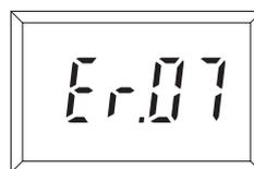
Отображение ошибки по результатам самодиагностики на внешнем индикаторе (датчик неисправен)
