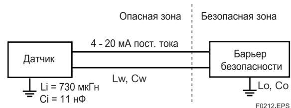
Рисунок 2.5. Схема подключения барьера безопасности
