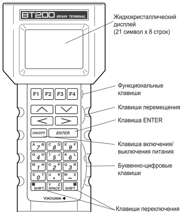
Рисунок 7.2.1а Расположение операционных клавиш на клавиатуре прибора BT200
