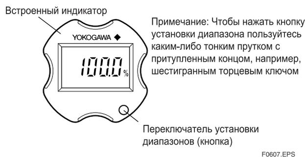
Рисунок 6.5.1 Переключатель диапазонов
