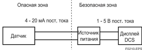
Рисунок 2.3 Пример использования DCS (Распределенной системы управления)
