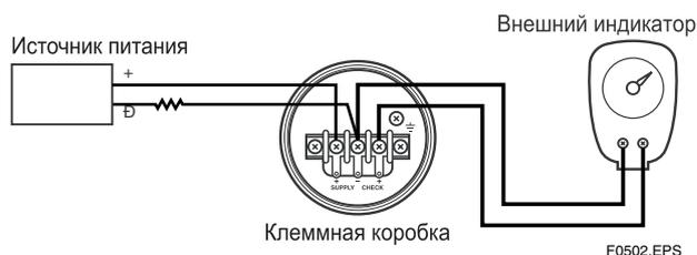
Рисунок 5.3.2. Подсоединение внешнего индикатора
